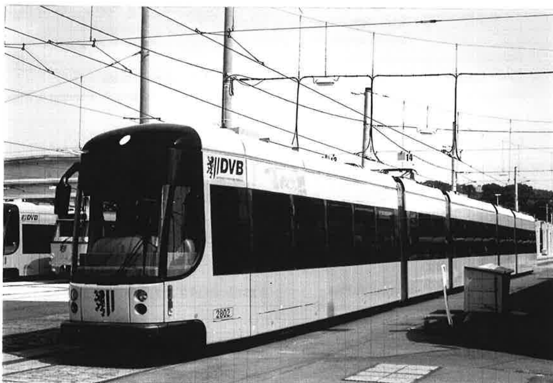
Les premiers exemplaires du CITADIS de BOMBARDIER ont commencé à circuler à Dresden. C'est ce type de véhicule, d'une longueur de 43 m, qui vient d'être commandé en 19 exemplaires par la STIB pour équiper la ligne n° 3 (Photo Guy Bridoux)
